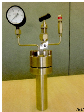
Figure 1 – Exemple d'autoclave pour l'essai de vieillissement du MIE
